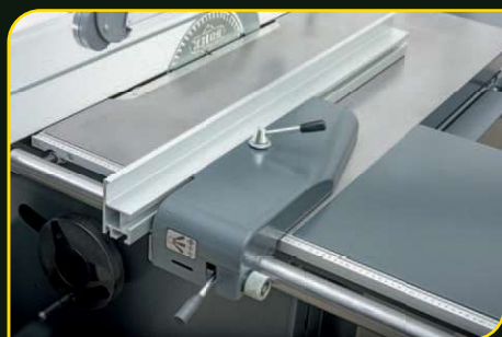
Podélné pravítko s jemným doladěním
