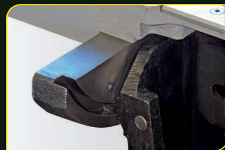
Masivní uložení mechaniky pily
