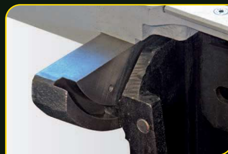
Masivní uložení mechaniky pily
